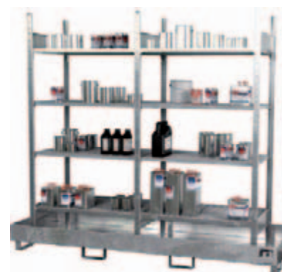
B-3023-4E Estantería inicial con estantería adicional 4 niveles (2x4 rejillas) + Cubeta de retención MED. CUBETA: 2400x800x250mm. CAPACIDAD: 1 x 200 l. PESO: 204 kg.
