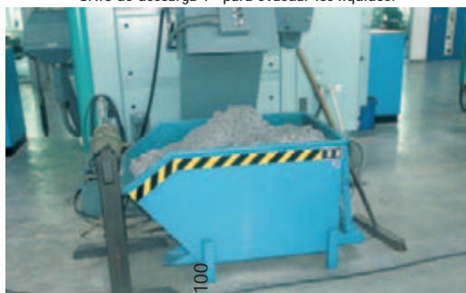
Cuadro de base estable con entrada de horquillas. Grifo de descarga 1" para evacuar los líquidos.
