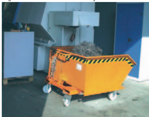
Cuadro de base estable con entrada de horquillas. Grifo de descarga 1" para evacuar los líquidos.
